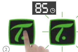
② Taste „TEA MASTER“ drücken. Tee wird zubereitet. Im Display wird die verbleibende Zeit in Sekunden angezeigt und die Taste „TEA MASTER“ blinkt grün.
