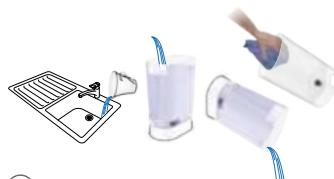
⑥ Entkalker wegschütten. Wassertank spülen und mit einem sauberen weichen Tuch reinigen.
